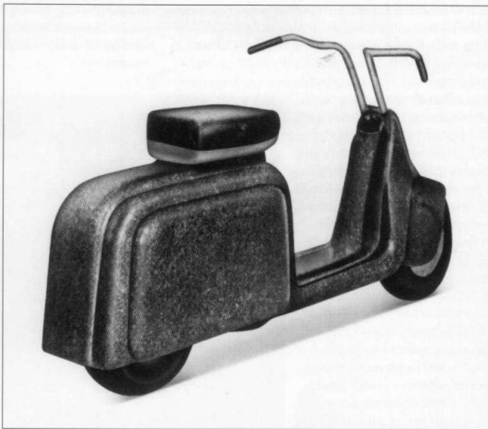
Il prototipo del 1945 caratterizzato dalla scocca portante e da un inedito motore bicilindrico.
