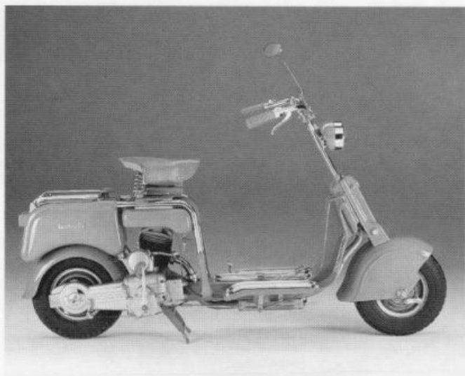
Una delle ultime Lambretta A della seconda serie, notare il pedale del freno posizionato sul lato sinistro della pedana.
