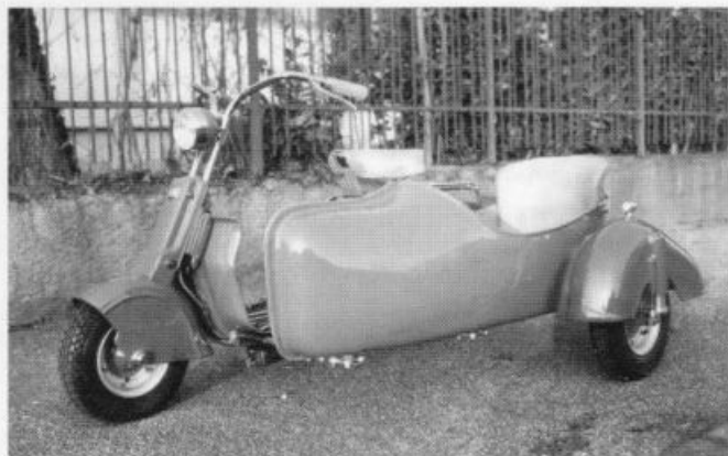
125 A del 1948, Sidecar in fusione d'alluminio prodotto dalla ditta Durapid.
