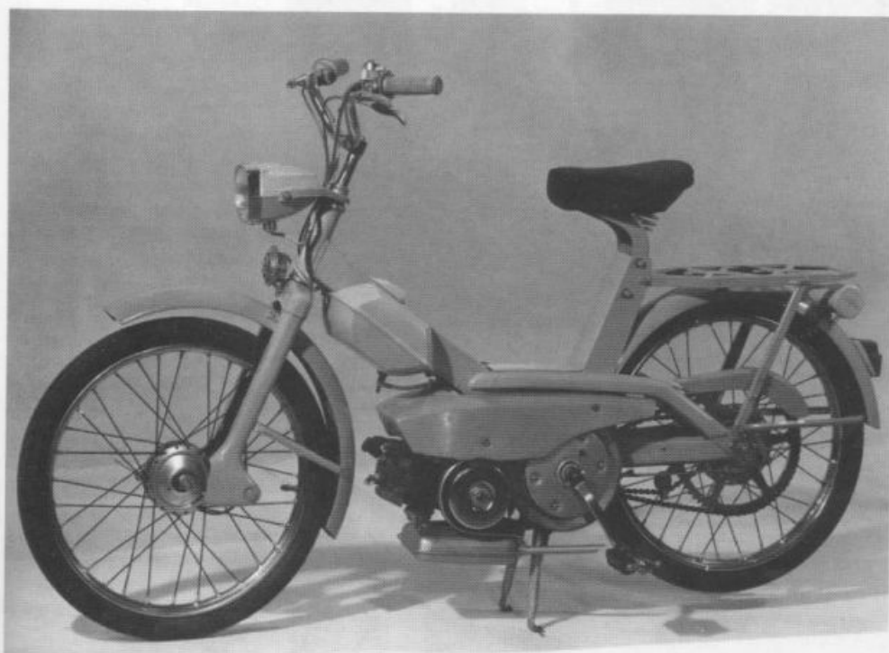
Il Lambrettino nella versione SX Automatic perde la sportiva marmitta cromata in favore di una più convenzionale a sogliola fissata direttamente al motore. Osservare le incredibili dimensioni della corona posteriore!
