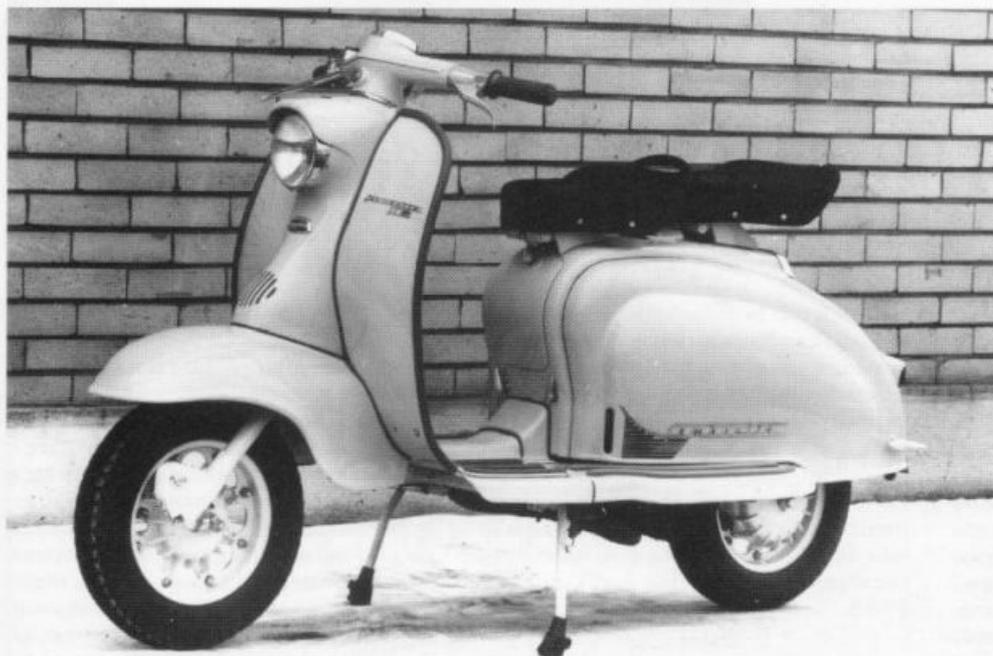
Il prototipo della LI fotografata all'interno degli stabilimenti Innocenti. Notare l'assenza dello sportellino per accedere al claxon e il mozzo anteriore di dimensioni ridotte. I fori sui cofani sono caratteristici della primissima produzione.
