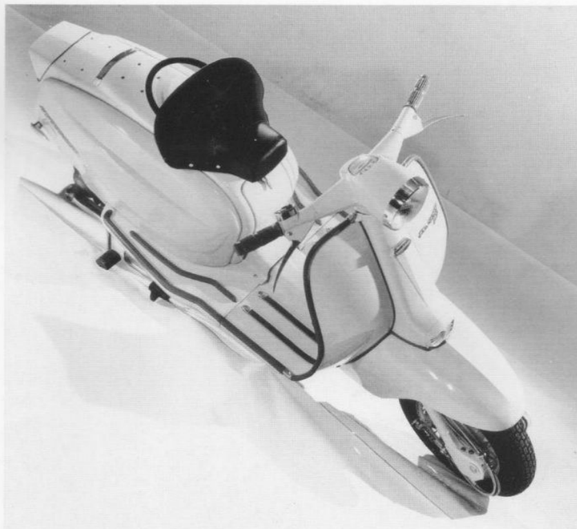
125 LI IIIs - prima versione 1962. Notare i braccetti porta leve verniciati.
